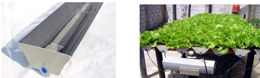
FIGURA 01– Modelo de calha autocompensadora, com detalhes do pavio de algodão e da sub câmara, utilizadas no cultivo da alface americana, variedade Lucy Brow, Juazeiro do Norte, CE. 2007.
